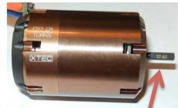
Bei neuen Rotoren ist, zwecks besserer Identifizierung von Außen, die Rotorwelle markiert.
